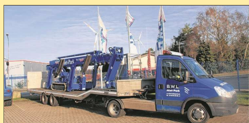
Große Maschinen wie diese Arbeitsbühne „Leo 30“ mit 30 m Arbeitshöhe werden per Tieflader transportiert.
